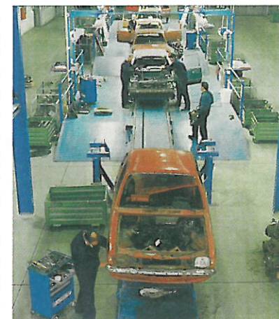
Futószalagon végzett járműbontási technológia
