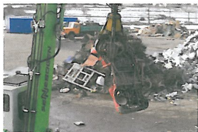
Roncsautó adagolása shredderre
